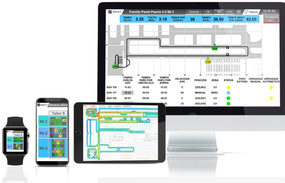
Ejemplo de monitorizado, gestión y control de AGVs en tiempo real y aplicación del gemelo digital
